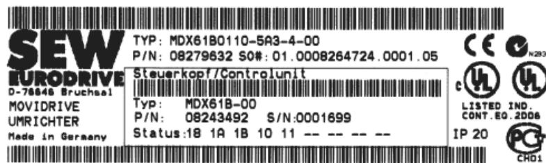
Afbeelding 3: voorbeeld typeplaatje MDX61B.., bouwgroote 1 – 6
